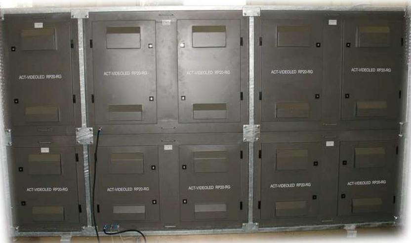
LED-Module können im Bedarfsfall auch unterschiedliche Größen haben. Die Aufnahmekonstruktion ist denkbar einfach, diese Arbeiten kann jeder örtliche Stahlschlosser durchführen. ACT liefert hierfür eine exakte DWG-Zeichnung der verwendeten Module mit allen relevanten Details für diese Unterkonstruktion.
